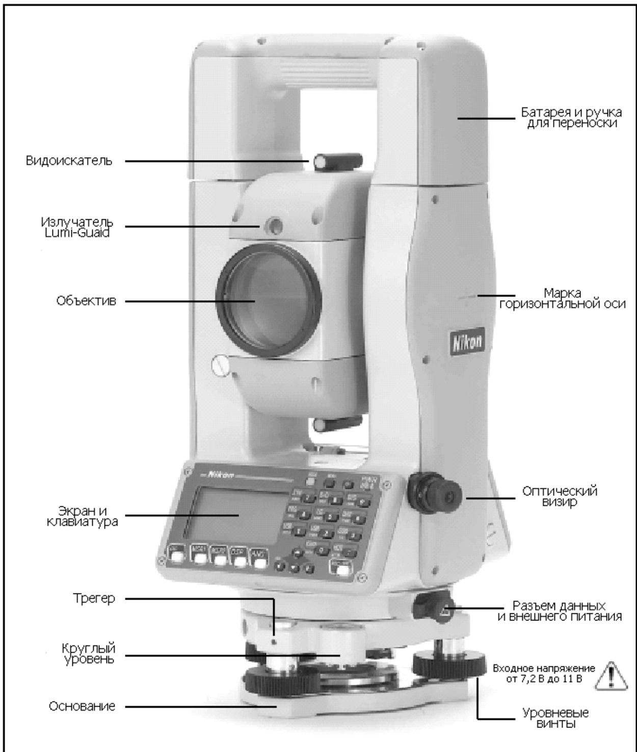
Рисунок 1.2 Электронный тахеометр серии Total Station DTM-502 –Сторона 2
