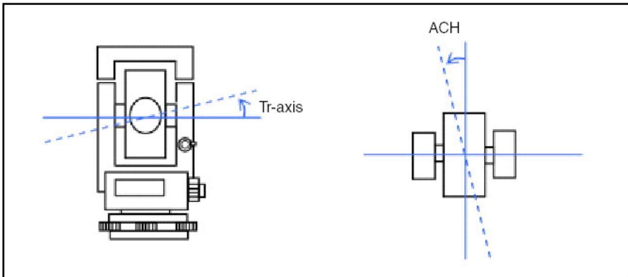
Т.к. величина компенсации соответствует вертикальному углу, при применении компенсации прибор слегка изменяет горизонтальный угол, даже когда вы затянули зажимной винт.
