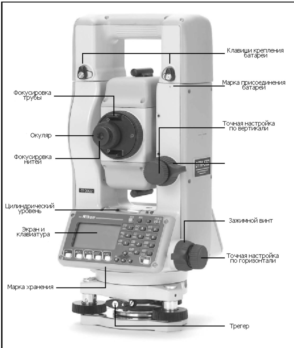
Рисунок 1.1 Электронный тахеометр серии Total Station DTM-502 – Сторона 1
