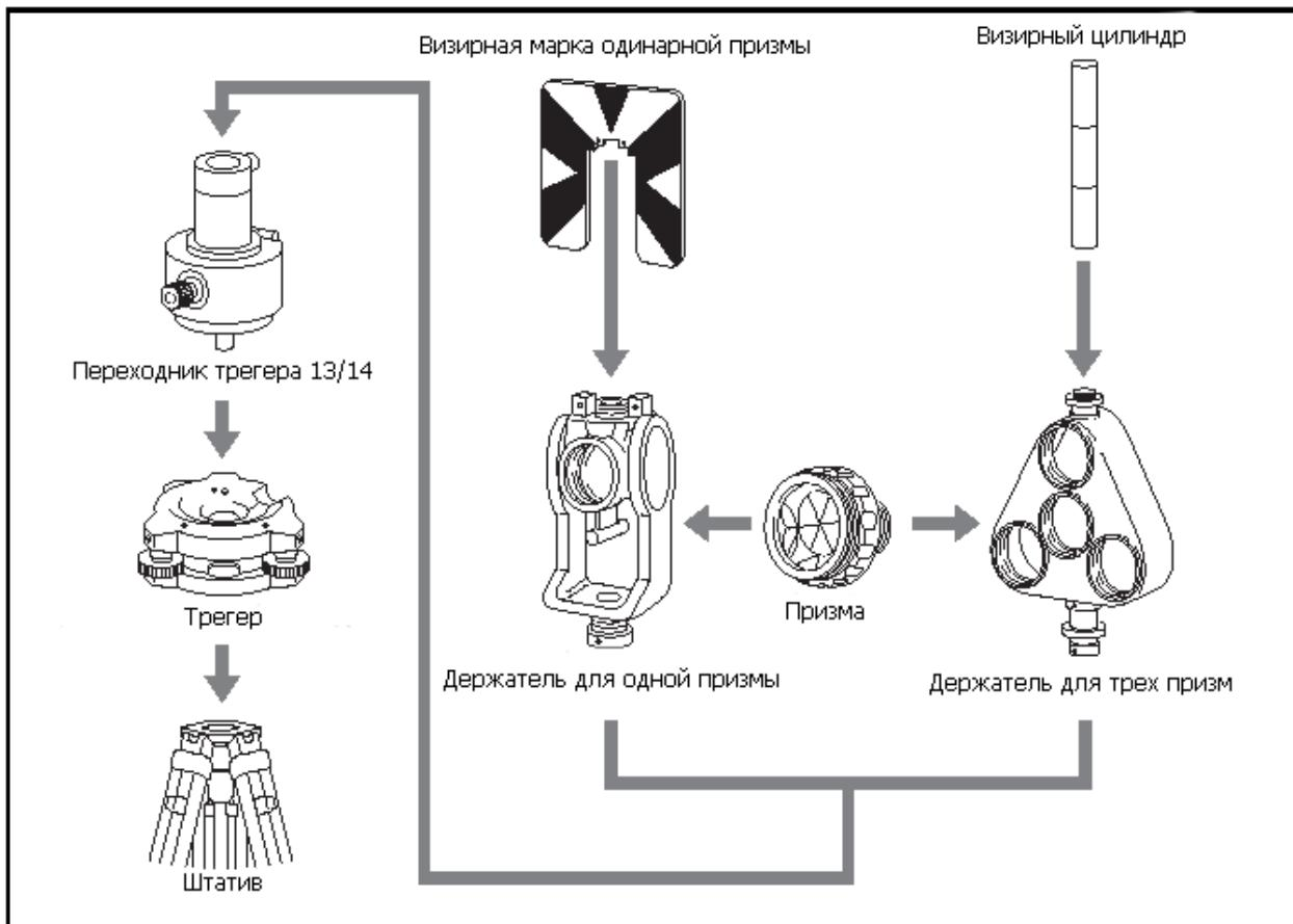
Рисунок 2.1 Сборка призменного отражателя.
